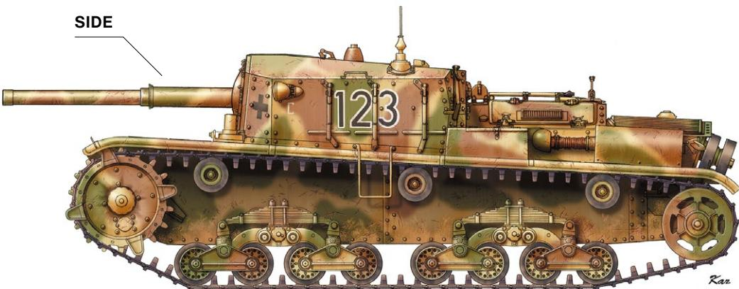
▲休戦後の1944年にイタリア戦線で展開したドイツ国防軍第162歩兵師団第246戦車獵兵大隊所属のM42 da75/34セモヴェンテ（自走砲）「123」号車。車体はダークグリーンとレッドブラウンの雲型の3色迷彩が、狭い間隔で塗られている。ドイツ国家章は白縁のない黒い十字で描かれている。こうした黒または白い十字章は、イタリア戦線の独軍鹹獲車両でしばしば見られた。戦闘室側面に付いた3個の器具はジェリ缶ラック。また履帯の脱落防止用に起動輪側面に新たに装着された4個の大型の爪に注目。
