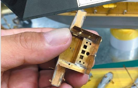
▲エッチングパーツで、なおかつ強度が必要な部分ははんだ付けで組み立てていく。箱組の裏側から接着しよう
