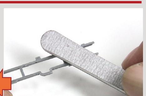
▲後部構造物の組み立て。ここは船体と接する面が広く、この部分に窪みや凹凸があると船体に取り付けた際に隙間が発生してしまうので、接着面も平らにしておきましょう
