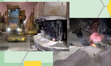
結晶を水洗いして焼成炉という設備で1000度以上の光熱で焼いて水分を飛ばすと真っ白な粉・アルミナができるの。あなたも1000度以上で焼かれたら骨だけが残るのよ
