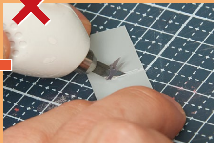
▲プラスチックやゴム系樹脂は切っている感覚がないくらい簡単に切れる。ちなみに、よく使われている樹脂製のカッティングマットを敷くとカッティングマットもサクサク切れてしまう
