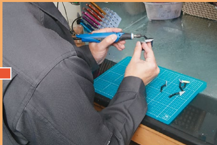
▲ストロークが縦なので、ヒジをつけてパーツとアルティマ7を固定するようにするとほとんどブレない。ブレないので狙った面にきれいにヤスリがけできるのだ
