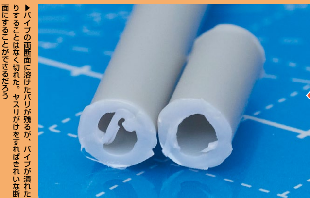
▲超音波カッターで切るときは、ガラスや金属などデザインナイフの刃で切れないものを敷くようにするか、バイスなどでパーツを固定して持つようにするとよいだろう
