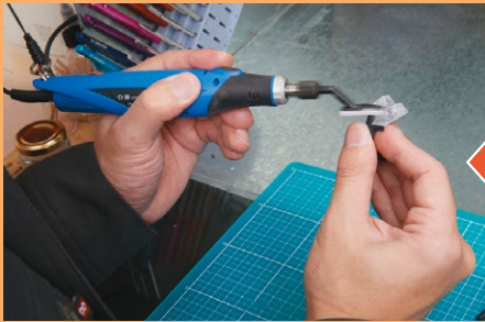
▲スポンジヤスリを装着したアタッチメントに交換して番手を上げてヤスってみる。これも一気に仕上がっていく。たくさんパーツの表面処理をするときには心強いツールだ
