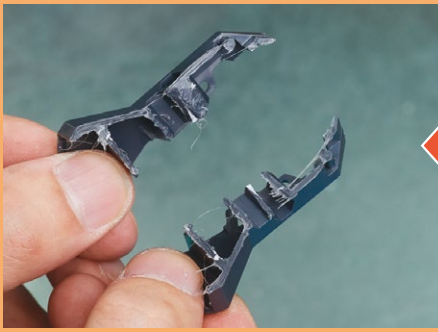
▲超音波カッターでプラスチックパーツをカットした断面。一部が熱で溶けて糸状になっている。精度の高いカットにはあまり向かないが、手で手早くカットできるのは大きな魅力
