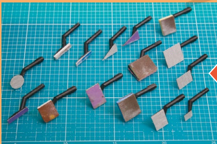
▲がっとなる氏が実際に使っているアタッチメント。アタッチメントを追加して同じ形状のものにヤスリの番手を変えて貼りつけて使うと効率的にヤスリがけができる
