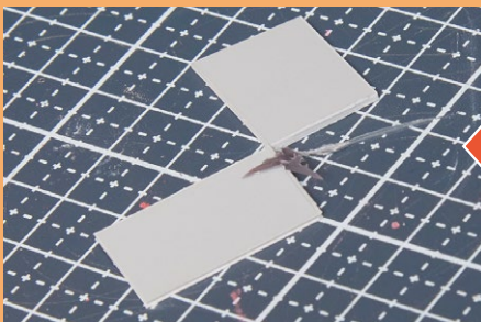
▲超音波カッターで切るときは、ガラスや金属などデザインナイフの刃で切れないものを敷くようにするか、バイスなどでパーツを固定して持つようにするとよいだろう
