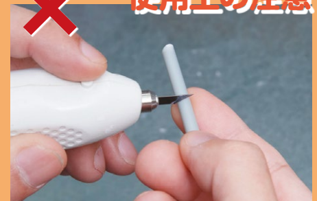
▲先は鋭いデザインナイフの刃になっている。刃がパーツに思ったよりサクッと入って指を切ってしまうようパーツの持ち方は注意しよう。刃の進行方向に指を置くのは危険だ
