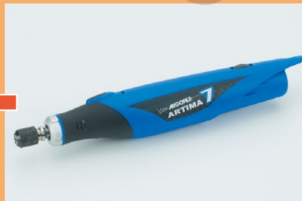
▲アルティマ7本体の重さは89gほど。1000~5000回転/分(無段変速)で縦にストロークする。アタッチメントに合わせたヤスリ切り抜き用の専用定規も付属する
