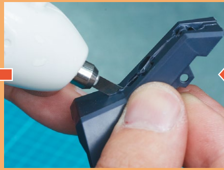
▲力を入れなくてもどんどん切り進んでいける。これが「バッテリーを切るようにプラスチックが切れていく」感覚。パーツの裏側の凸凹までいちどに切ることができる
