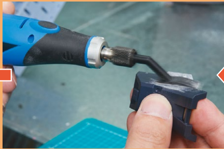
▲次にアタッチメントを長方形のものに変えてみる。広い面をヤスリがけするときに非常に効果的なアタッチメントだ。これくらいの面の大きさならすぐに整形できる
