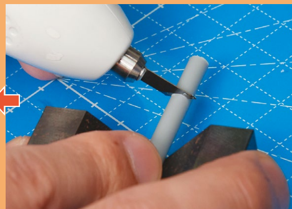
▲プラスチックだと溶けるので精度は出しにくい。では実際にどのくらいの精度で切れるのか、プラスチックパイプをカッターでみる実験をしてみた
