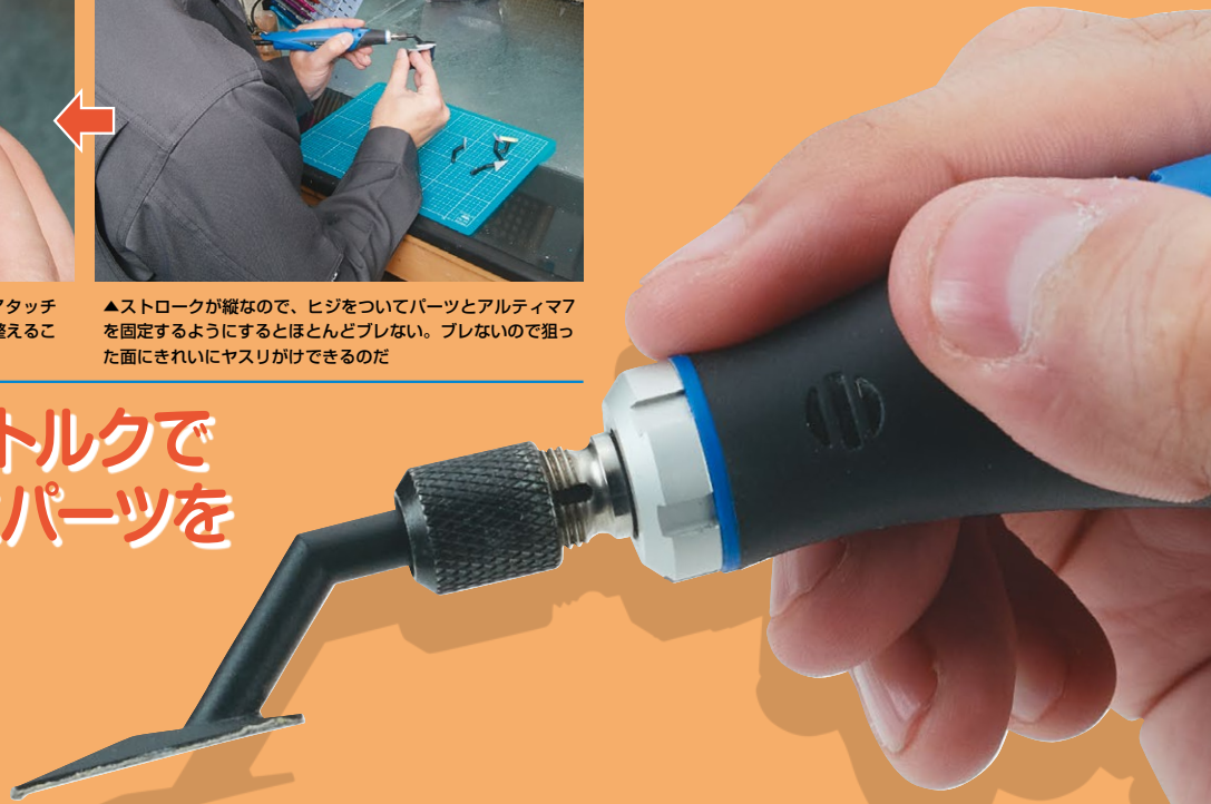
▲次にアタッチメントを長方形のものに変えてみる。広い面をヤスリがけするときに非常に効果的なアタッチメントだ。これくらいの面の大きさならすぐに整形できる
