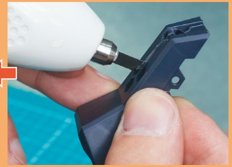
▲プラスチックパーツを切断してみる。超音波の振動で刃の摩擦を減らして切っているが、振動によって出る熱で刃がプラスチックを若干溶かしながら切れていく
