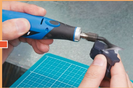
▲パーツ表面のうねりを除去してみよう。まず三角形のアタッチメントでこまかい切り欠き部分の表面をヤスってみる。あっという間にたいらにならすことができた
