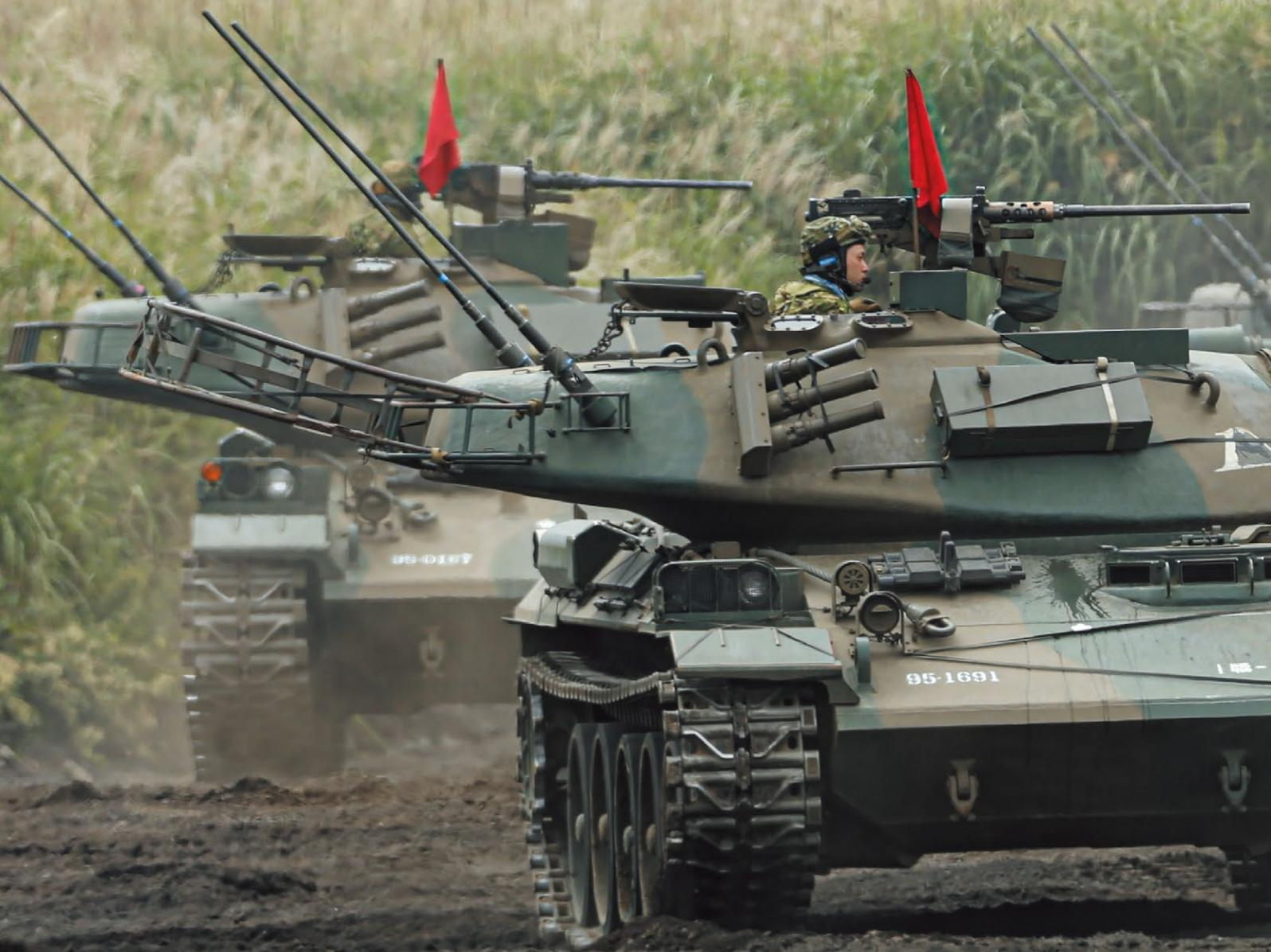
▲射撃訓練を行なう第1戦車大隊第2中隊の74式戦車小隊。弾薬の装填中を示す赤旗を立て、砲塔後部には戦闘積載用の大型ラックを追加装備している。2020年9月16日の撮影。 写真／武若雅哉
