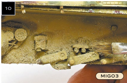
▲MIG01をモールドの陰に流して別パーツ感を強調する。サスペンション可動部にMIG13でグリスの滲みを追加してツヤを加えると効果が高まる。
