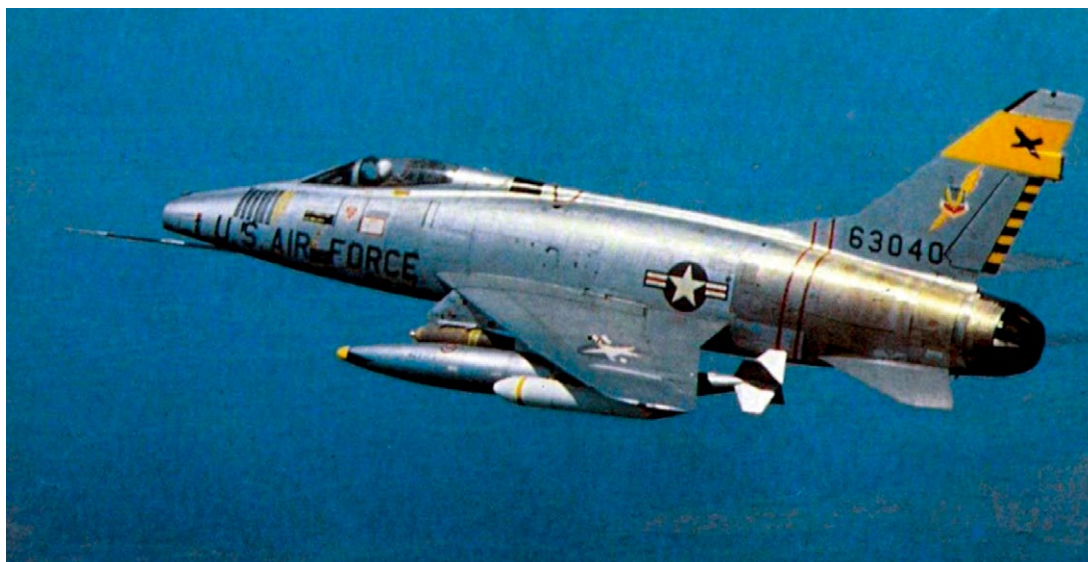
1965年、CBU-28クラスター爆弾とM117爆弾を搭載して南ベトナム上空を飛行する第429戦術戦闘飛行隊の迷彩のないF-100D-70-NA、s/n56-3040 (USAF)
