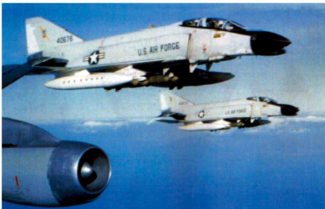
M117 750ポンド爆弾と AIM-7スパローレーダー誘導ミサイルを搭載し、北ベトナムの目標に向かう第45戦術戦闘飛行隊のF-4C、1965年。先頭はF-4C-22-MCファントムII、s/n64-0676(USAF)
