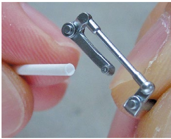
▲チェンジペダル頭は若干短いので、1.5mm径のブラ棒で延長することに。短い先端がすっぽり入るぐらいの穴を開けて被せるように接着すると強度も出せる
