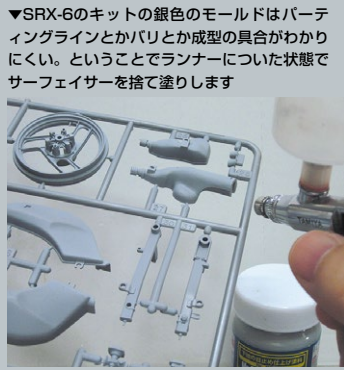
▲すると段差やバリやら、いろいろ見えてきます（ブレーキディスクの外周部分に注目）。発売から30年近くも経つキットなのでそれなりにバリがあります
