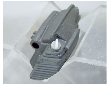
▲オイルタンクには2mm径ブラ棒のスラストとブラ板の小片で給油口のフタを追加した。金型の抜き方向を考えると省略されているディテールを見つけやすい
