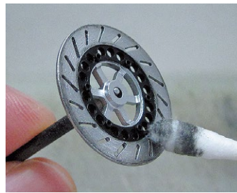
▲ブレーキディスクは銀塗装後にエナメル系塗料のガンメタルで擦り痕を表現。高速で擦れた感じを思い描きつつ、塗ったり拭いたりしながらいい塩梅を見つければよい
