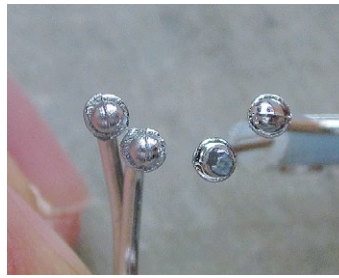
▲解決は簡単。繋がった状態で成型させてしまっているホースのジョイント部を割って、斜めに合わせるように角度をつければいい。多少の曲げなら表面のメッキも傷まない
