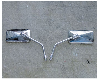
▲ステーは1mm径のステンレスパネ線を使用。ちなみにミラー面はペットボトルの丸い部分を切り出してハセガワのミラーフィニッシュシートを貼ることで曲面ミラーとした
