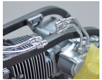
▲このキットでもっとも気になる部分だが、このオイルクーラーのホースのねじれ。上下から伸びるパーツがホースの接続部分で90度ずれる位置になっているのが原因だ
