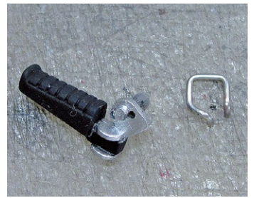
▲リアステップのヒールガードを金属線で追加してやる。材料は0.6mm径のすずメッキ銅線。適度に柔らかく、ピンセットで摘まんでクネクネと整形ができるので便利だ
