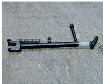
▲サイドスタンドを取り付けてみるとすいぶん車体が傾いてしまうことに気がついた。試しに2mmほどのゲタを噛ませるとまあまあ角度になったので、スタンドを延長工作した
