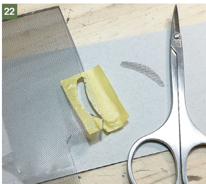
22 ▲カウルのエアインタークは、内側にメッシュを貼りたい。まずキットのパーツのエアインターク部を開き、その穴をトレースしたマスキングテープを形にしてメッシュを切り出す
