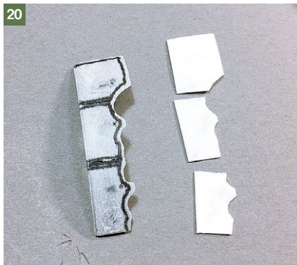
20 ▲右が切り出したままのプラ板、左がキットのカウルフラップに貼り付けた状態。当たり前だけど、加工後はばっちりカウルの湾曲に沿った形になってます
