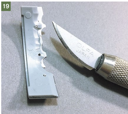
19 ▲キットのカウルフラップに切り出したプラ板を貼り付けて、キットのパーツの裏面を削り込む。こうすると、カウルにあった自然なアールになるわけです
