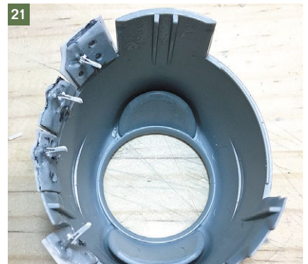
21 ▲0.5mmのプラ棒とプラ板を使って、カウルフラップ裏面のコントロールロッドを自作。キットのカウルフラップの厚みを糊代にしつつ、開いた状態でカウルに取り付けたら完成
