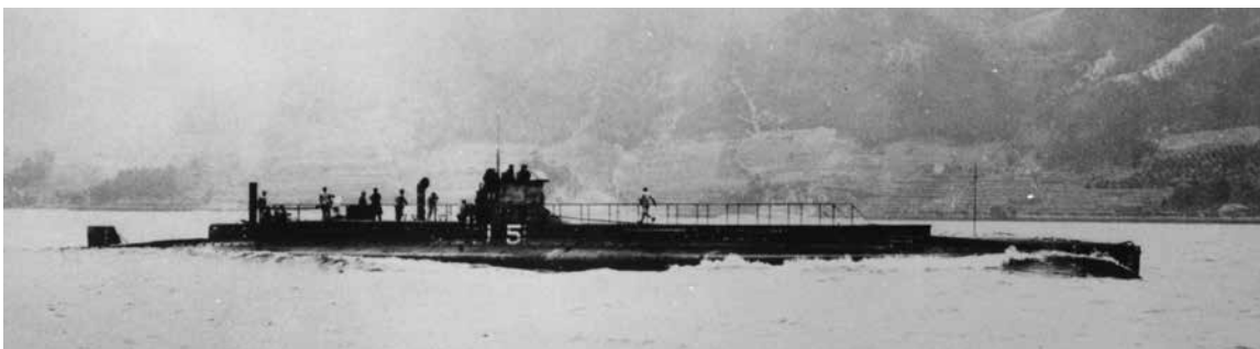
▶「第21潜水艇（のち呂2）」。イタリアのラウレンティ式设计は各国の興味を引いたが、洗練された外見とは裏腹に実用性が乏しいと評された。
