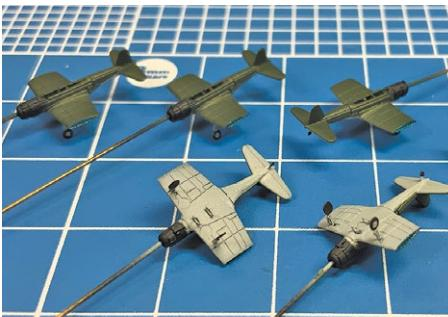
機体の基本塗装を完了。カウル、タイヤ部分は筆塗り、それ以外はエアブラシによる吹き付け。
