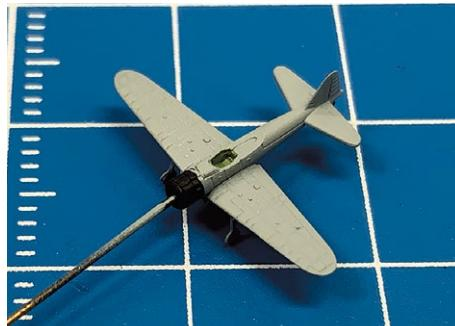
コクピットを再現するためにタガネで正方形に彫って形を整えこの後に座席を取り付けます。
