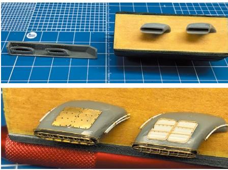
煙突の工作。非常用排煙装置はエッチングパーツを使わずブリ材と汎用エッチングパーツで自作。
