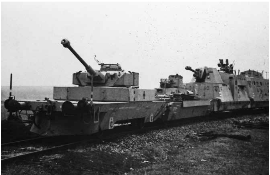
BP44とBP42の大きな相違点は、ドイツ製10.5cm軽榴弾砲の採用とIV号戦車（長砲身型）砲塔を搭載した装甲砲兵車両などの増強である。BP44の見慣れた写真であるが、撮影時期は1944年春と思われる。
