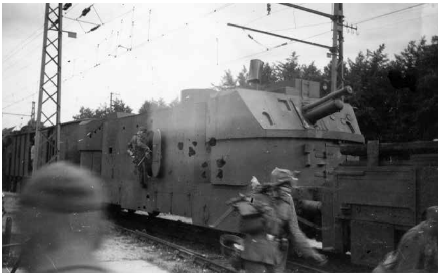
1942年に西フランス方面で撮影されたPz22の貴重な写真。手前が装甲砲兵車両、後方が装甲歩兵車両である。ご覧のとおりポーランド製の7.5cm軽野砲wz.02/26 (p)へ換装されており、砲塔もカーゼマツ方式を採用し強化されている（注：中央の黒い斑点はオリジナル写真の汚れである）。
