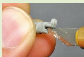
18 ▲ドリルで掘った穴にデザインナイフの刃先を入れて袖口のエッジが薄くなるまで削る。
