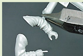
01 ▲シワなどのモールドを損なわないように注意してランナーから切り離す。
