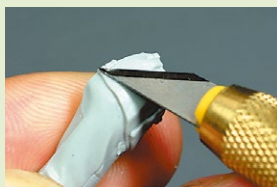
02 ▲デザインナイフでゲート痕を少しずつ削り取ってゆくとキレイに仕上げられる。
