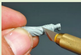
06 ▲シワ部分の奥まった部分のパーティングラインもデザインナイフの先端で処理できる。
