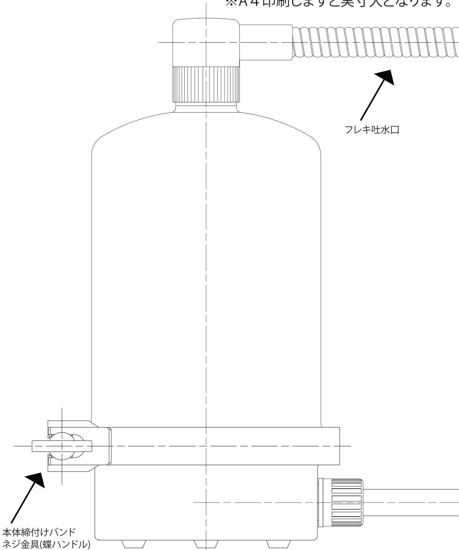
※フレキ吐水口の長さは20cmです。フレキ吐水口及び、浄水ホース接続部、本体締付けバンドネジ金具の方向は、変更可能です。
