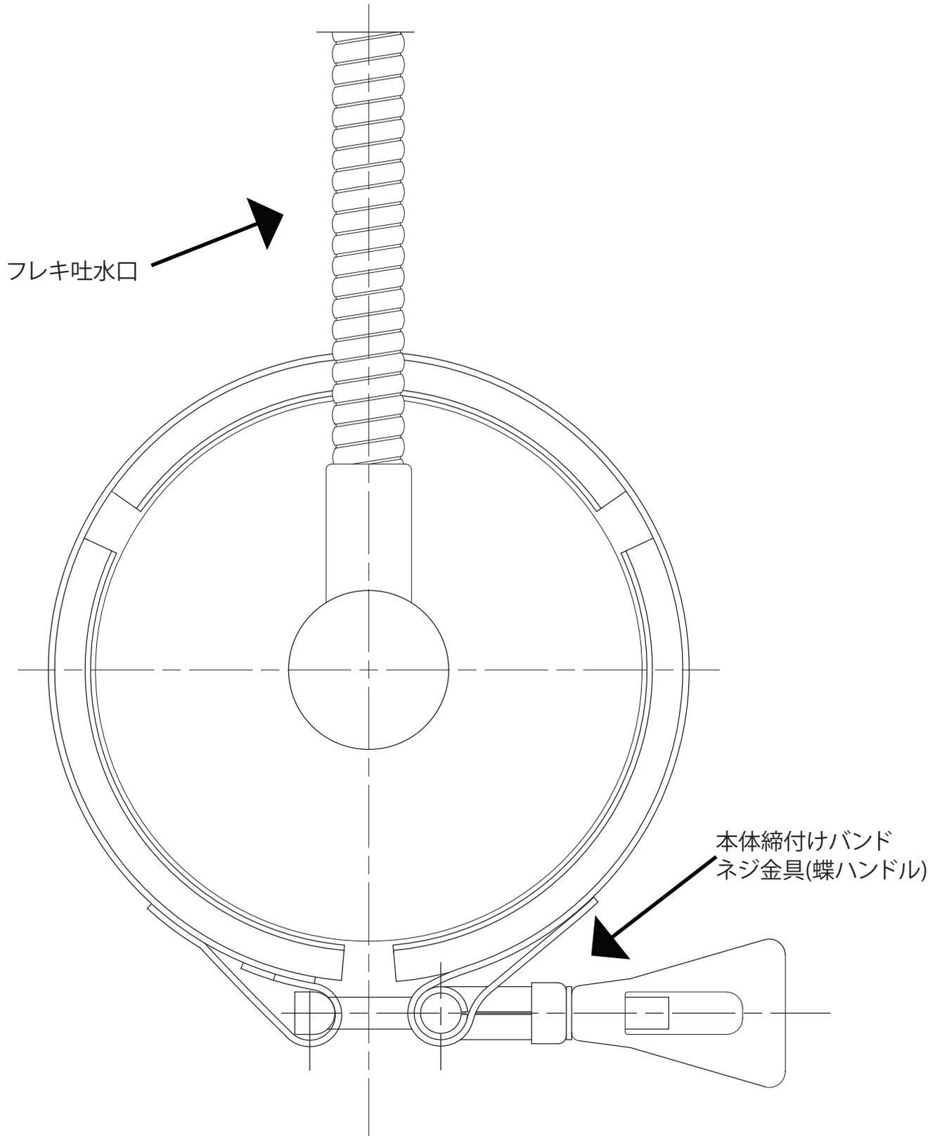
※フレキシ吐水口の長さは20cmです。フレキシ吐水口及び、浄水ホース接続部、本体締付けバンドネジ金具の方向は、変更可能です。
