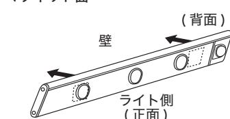
1. 付属のマグネットシートの青色のフィルムを剥がし、剥がした面をライト背面にある磁石が内蔵されている箇所に取り付けて下さい。
