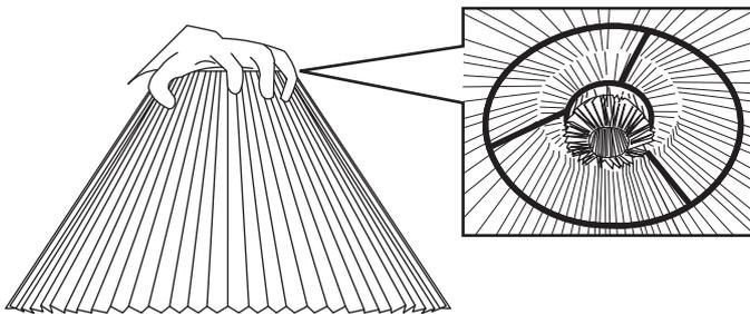
③シェード上面をすぼめて持ったまま、シェード内側の折り返し部分を灯具のフレームに引掛けるように固定します。
