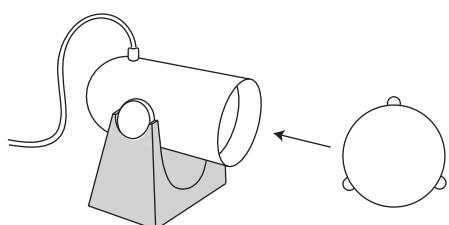
③カバーの端に3箇所ゴムのストッパーが付いています。そのストッパーをシェードの内側にはめるように設置してください。
