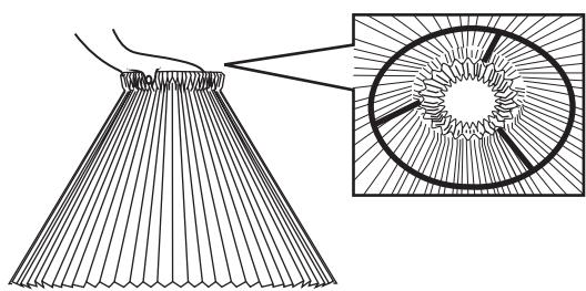
④ゆっくりと手を離せば、シェードの折り返し部分がフレームのリングに引っ掛けられ固定されます。
