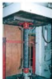
支柱強度試験1
