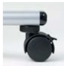
■アジャスト機能付キャスター キャスター上部のリングを回転させる事 によりレベル調整が可能です。
