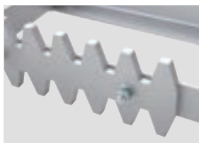
レーキ部厚さ12mm (摩耗してきたら上下付け替えて使用することが可能)
