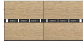
配線受けは左右にスライドする為、最大で約1400mmの隙間を作ることができます
