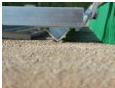
③アングルで削った土の均し作業
