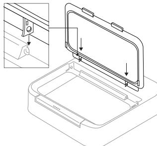
2. 卷きばねを外し、フタをフタ枠に挿入します。
