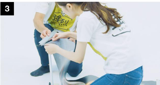
折り畳み式ポールを真っ直ぐになるように広げ関節部分を差し込み連結させます。
