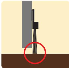
③ ドアの取り付け面の汚れを取り除き、ブラシの先端が床面にかるく接触する位置に合わせて両面テープで取付します。
