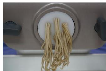
○最初に出てきた麺は十分に練られていないので生地に戻し再度押し出します。
