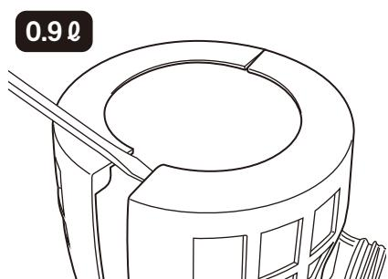
プロテクターの隙間にマイナスドライバーを入れ、プロテクターを外す。
