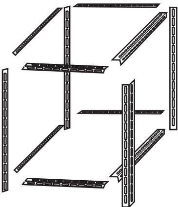
支柱用アングルの内側に幅用アングルと奥行用アングルが入るように枠を組み立てます。
