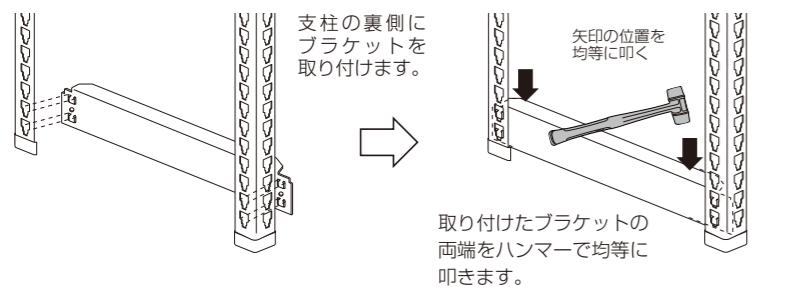
③②で組み立てた支柱と本体のL字連結金具に
