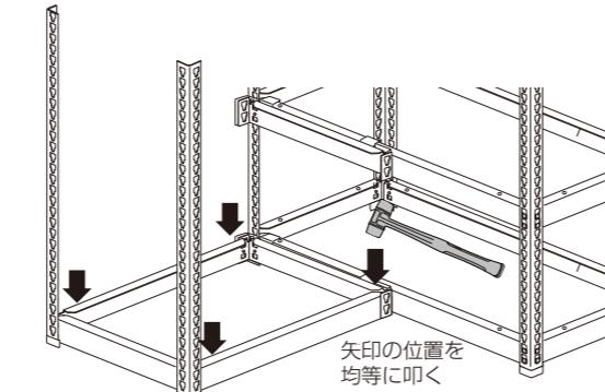
下段の支柱先端にジョイント金具を取り付けます。
