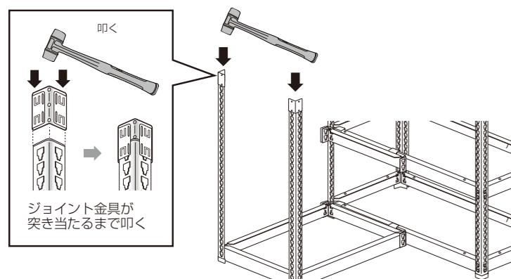
ジョイント金具の先端に残りの支柱を取り付けます。
