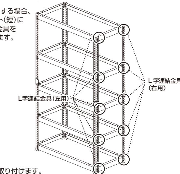
下記のL字連結金具の取り付け方を参考して、こちらの10箇所に取り付けます。
