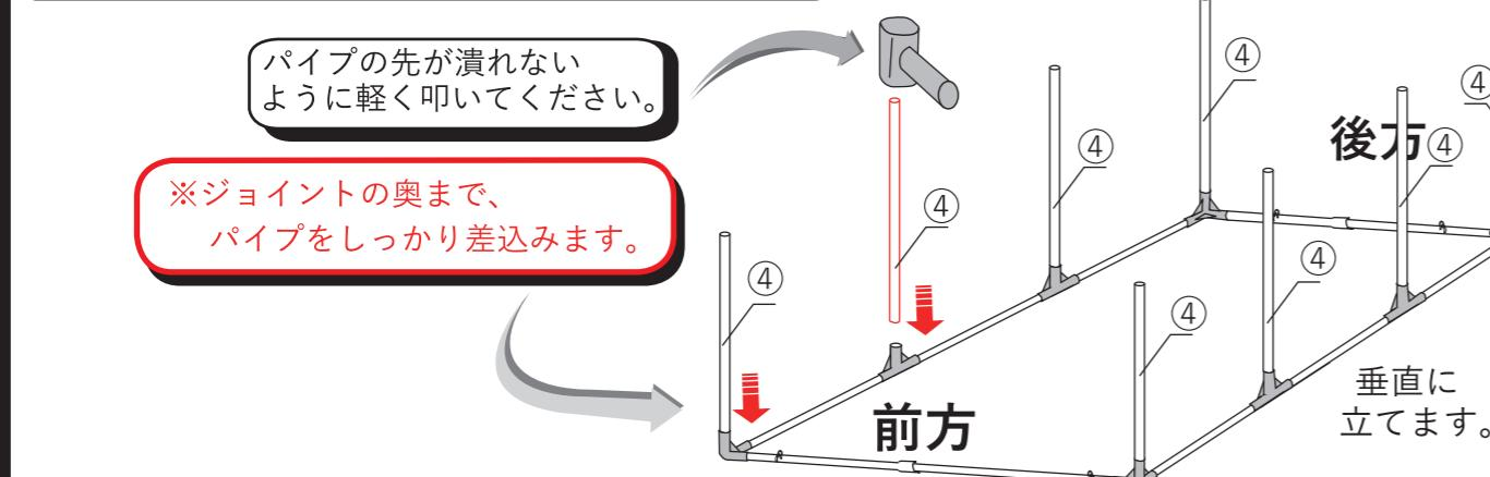
**5** 各ジョイントと⑤横通し用パイプを組立て、④脚用パイプに差込みます
