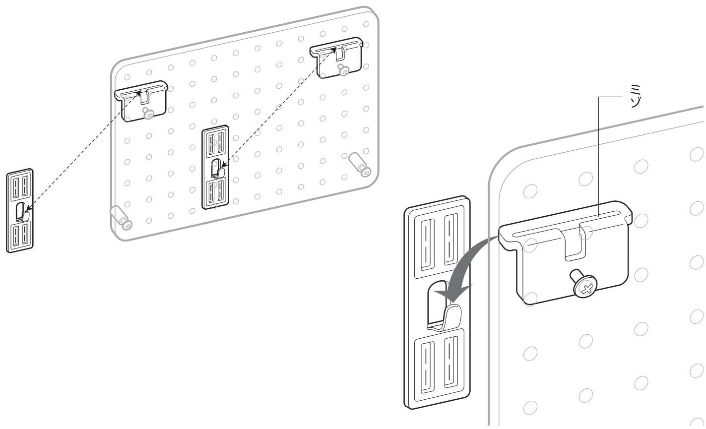
パンチングボードの下部にも壁美人金具を取り付ける事で下部のバタつきを抑える事ができます。(別売)
