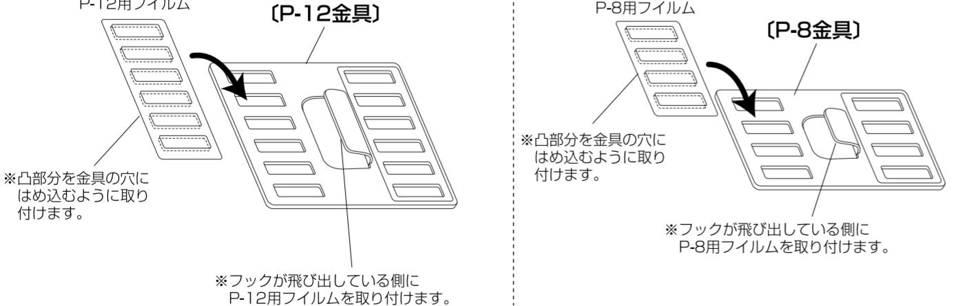
4 ■固定金具用ガイド用紙の左側の窓に合わせて金具を止める。次に右側の窓に合わせて金具を止めてください。
