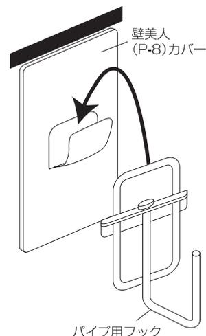
**6** 伸縮パイプの長さ調整用のネジを緩めて長さを合わせ、パイプ用フックに伸縮パイプの穴を通し長さ調整用ネジを締めて固定し、最後にマスキングテープを壁紙が剥がれないよう注意しながら剥がして、完成です。
