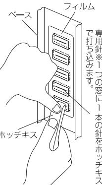
②ホッチキスを図のように壁面に対し少し斜め（約30度の角度）に打ち込んでいきます。
