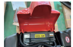
バッテリーは容易に脱着が可能（バッテリー重量14kg）
