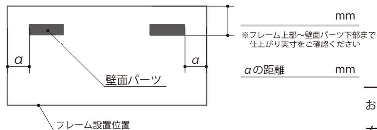
仕上がりサイズにより、フレーム裏面の棧の数が異なりますので、壁面パーツは棧に当たらない位置で固定してください。
