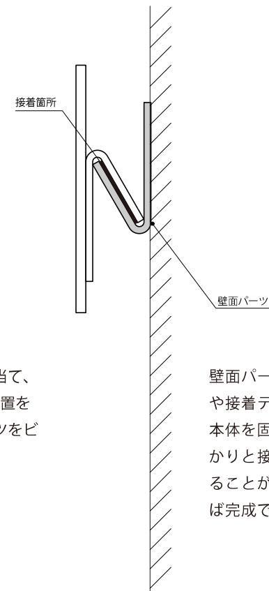
表札本体と壁面パーツを合わせて  $a$  の長さを図ります。
