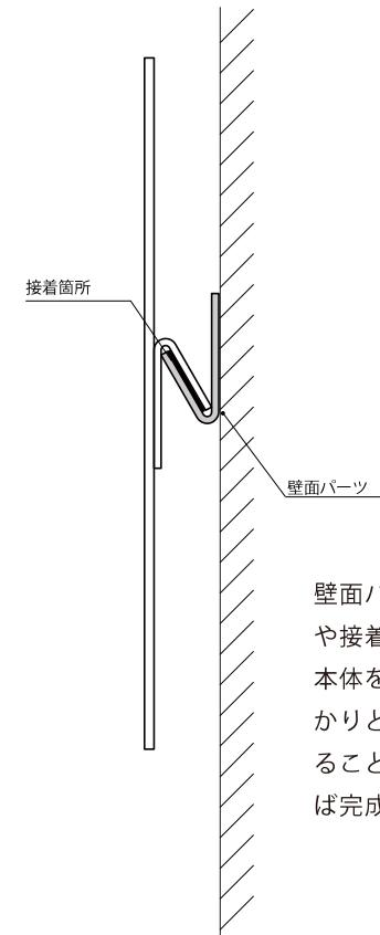
壁面パーツにボンドや接着テープをつけ、本体を固定し、しっかりと接着されていることが確認できれば完成です。
