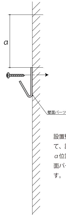
設置壁面に表札本体を当て、設置位置を確認後、 $a$  位置をとった距離に壁面パーツをビス留めします。
