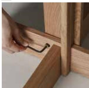
六角レンチを使い、六角ネジを仮止めします。反対側のネジも同様に仮止めし、両側を交互にしっかりと締め込んでください。
