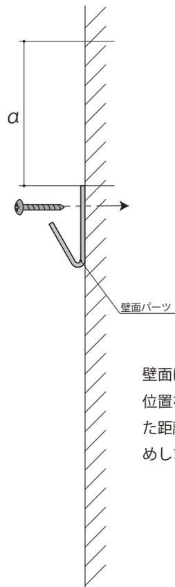
壁面に本体パーツをあてて、位置を確認し、 $a$  位置をとった距離に壁面パーツをビス留めします。
