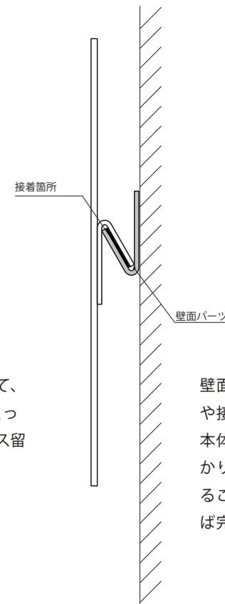
壁面パーツにボンドや接着テープをつけ、本体を固定し、しっかりと接着されていることが確認できれば完成です。
