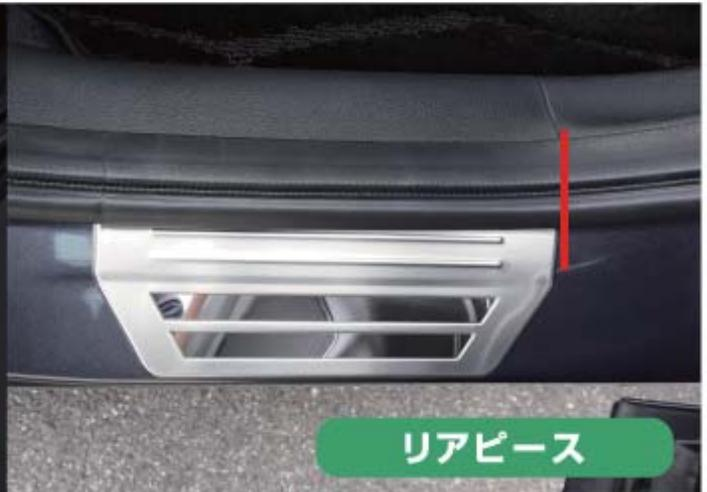
フロントピース・リアピース共に純正ステップ部分のフロント側のラインに合わせるようにして装着してください。
