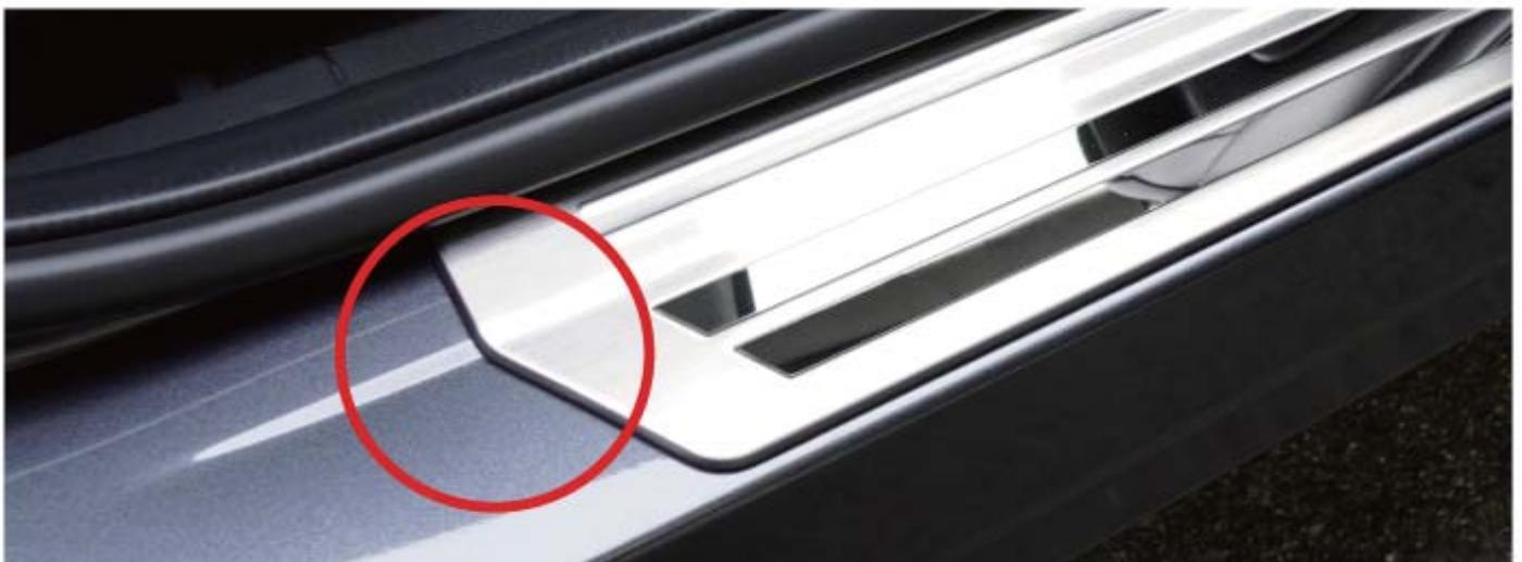
フロントピース・リアピース共に印部分の形状に合わせて装着してください。
