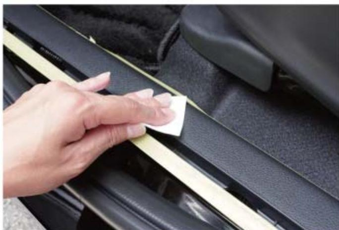
4) 付属の脱脂剤を使用して装着面の脱脂をします。
