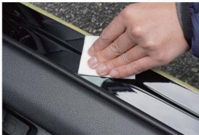
3) 付属の脱脂剤を使用して装着面の脱脂をします。
