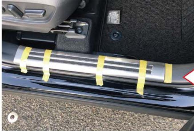
3) 取付位置を確認しながらパーツを車体に合わせます。位置に問題が無ければ付属のマスキングでパーツが動かないように固定します。
