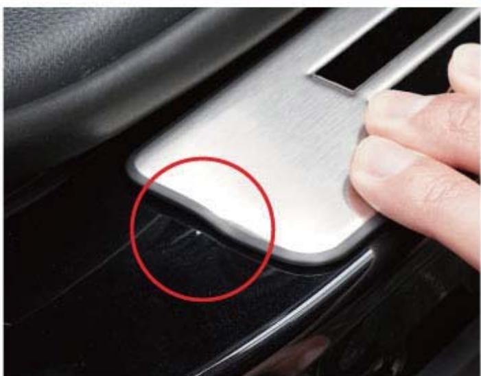
サイドステップのフロント側の段差になっている箇所から 9cm の位置にパーツの先端がくるように合わせます。
