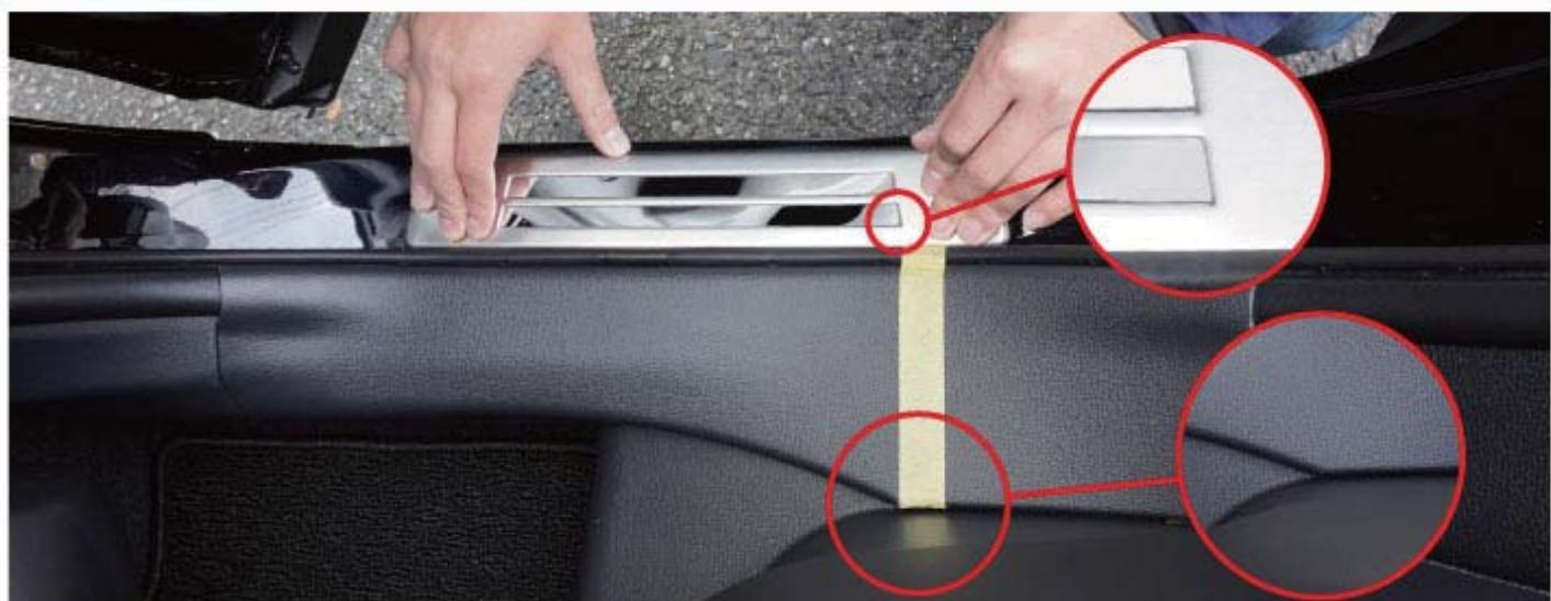
外側スカッフプレートの鏡面部分の端とサイドステップの出っ張った部分が一直線になる位置に合わせてください。奥行きの位置はフロントパーティと同様に段差に合わせてください。
