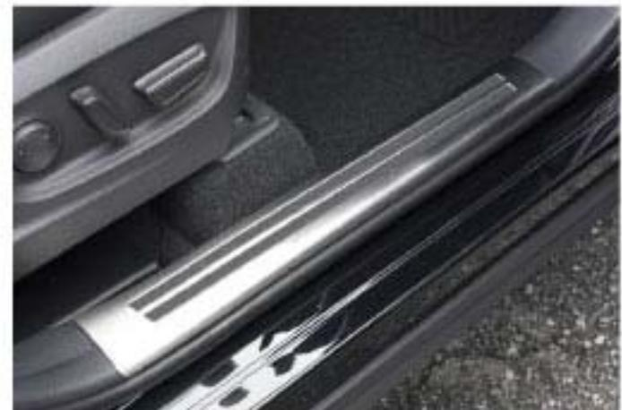
10) 圧着後にパーツが動かないようにマスキングテープを貼り付けて固定します。車を動かさずに約 24 時間しっかりと馴染ませます。
