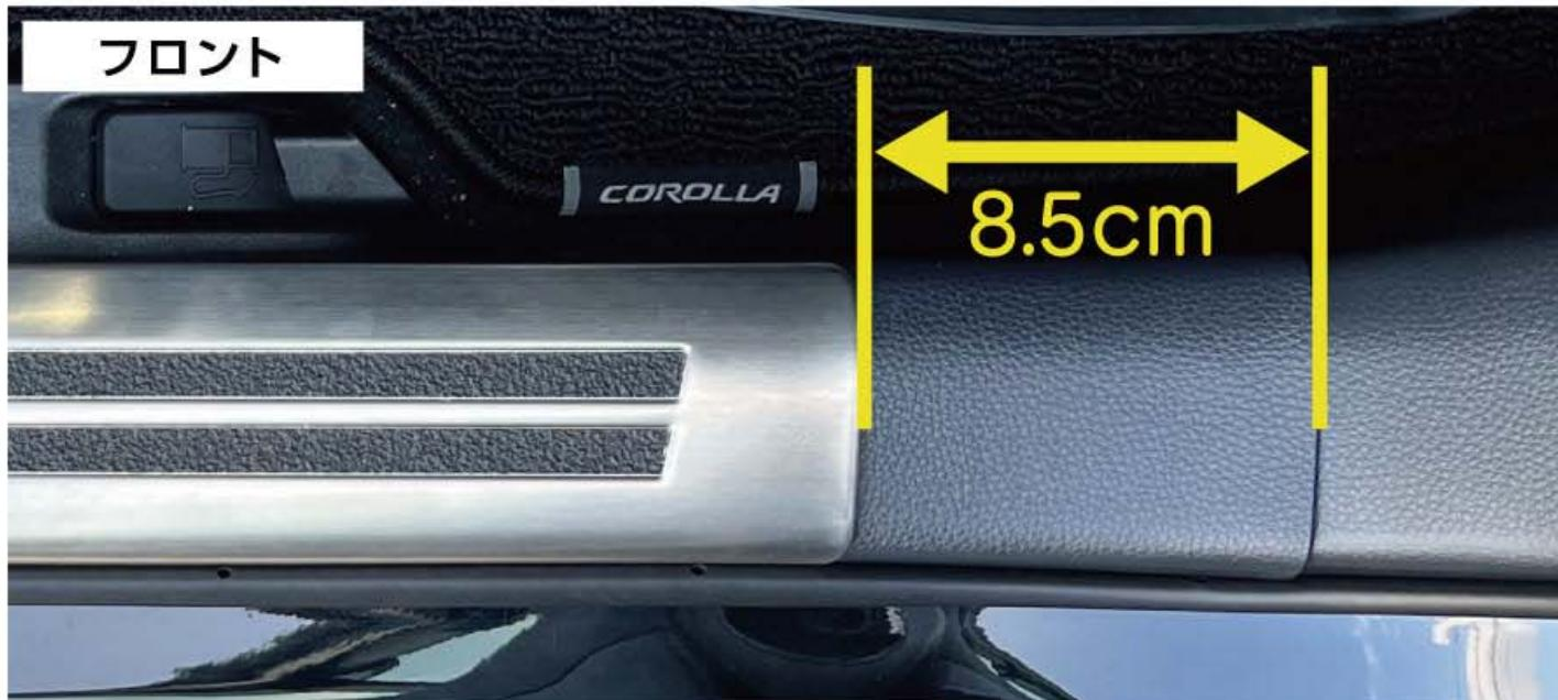
フロント側の2ピース（運転席・助手席）は純正樹脂部の先端から8.5cmの位置にスカッフプレートの先端を合わせてください。
