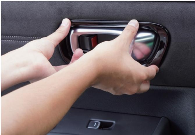
11) しっかりと車体に馴染ませた後、装着面に浮きや剥がれが発生していないかを確認します。万が一張り付いていない場合は、再度圧着・固定を繰り返してください。
