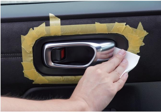
5) 付属の脱脂クリーナーを使用して装着面の脱脂を行います。
