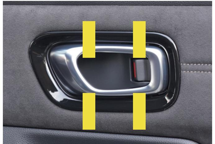
2) 形状に異常がなければ、付属のマスキングテープを使用して4か所程度貼り付けて仮止めを行います。
