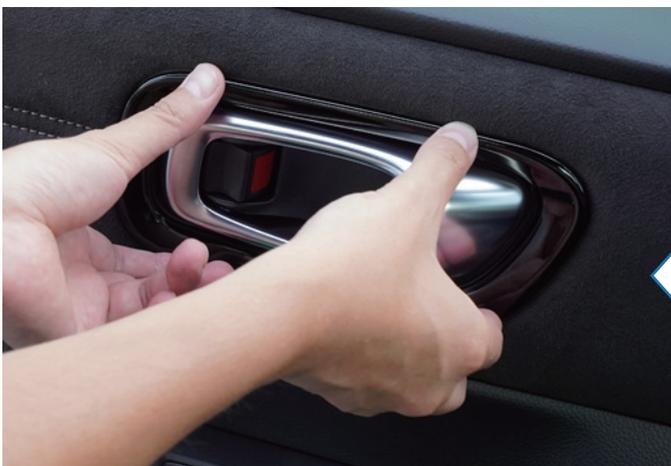
8) プライマーが乾燥したら、マスキングテープを剥がしてから、パーツの貼り付けを行っていきます。位置がずれないように慎重に作業を行ってください。
