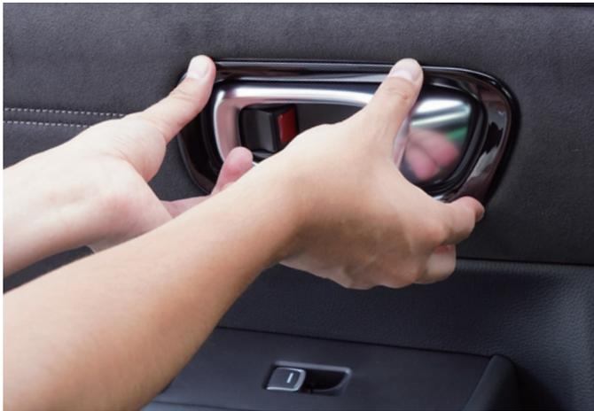
1) パーツを装着箇所に仮当てします。正しい位置に合わせてから、大きな浮き・変形が無いかを確認します。
