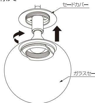
**警告** ガラスセードがしっかりとセードカバーに固定されているかを確認してください。
