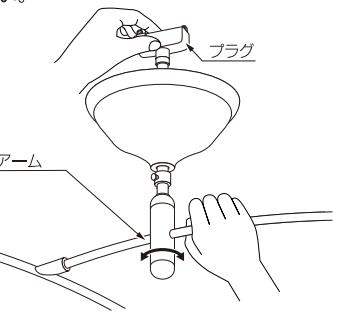
**警 告 WAR.** 点灯中は可動させないでください。可動させるときは消灯し、温度が低くなってから可動させてください。本体の角度を調整する時は片方の手でプラグを持ち、もう一方の手でアームを持って行ってください。可動範囲を越えて無理に可動させたり、周囲のものに触れる位置でのご使用は絶対におやめください。故障、火傷、過熱の原因になります。
