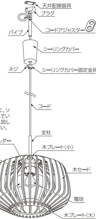
※組み立ての前に、ソケットにセットされているホルダーを左に回して取り外してください。
