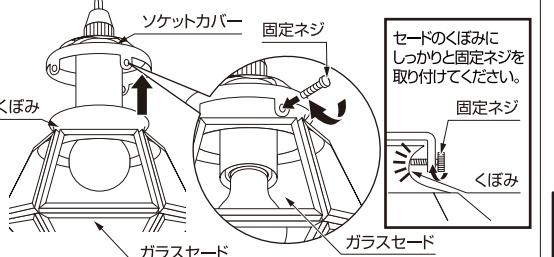
△ ネジを固定した後に再度、セードがしっかりと固定されているか確認してください。
