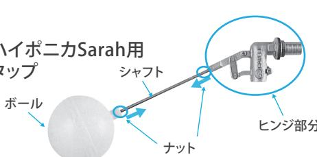
※取り付けられる際は、まずナットをシャフトの中心に向かってまわします。できたらナットをスパナ等で固く止めてからボールを付けてください。また、ヒンジ部分に無理な力が加わらないよう、プライヤーなどで固定し、ナットをしめてください。
