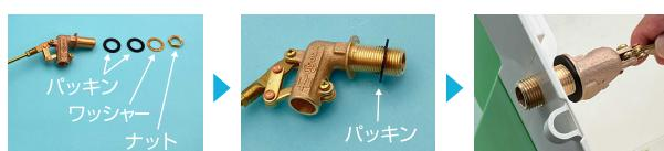
2. 栽培槽を挟み込むように、残りのゴムパッキン、ワッシャーの順に通し、ナットを締めてしっかりと取り付けてください。
