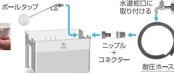
1. ボールタップに付属されているパッキン・ワッシャーなどを一度外してください。パッキンを1つ通した状態で、Sarah本体の側面にあるシールをはがして、取付穴に差し込みます。この時、ボールが液肥槽内にくるようにします。
