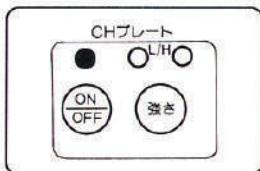
2 CHプレートON/OFFスイッチを押してCHプレートランプをON(点灯)にします。
