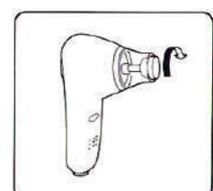
2 バッティングキャップをバッティング・リングのみぞに合わせ、右へ「カチッ」と止まるまで回して固定してください。(バッティングキャップはていねいに扱ってセットしてください)。次に本体よりコードを取り出しバッティングに接続してください。
