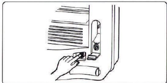
ペーパーライザー使用後は必ず排水ボタンを押し、本体に残っている専用水をすべて排水してください。なお排水したお湯(水)は再使用しないでください。
