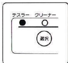
2 選択スイッチを押してテスラーランプをON(点灯)にします。
