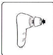
1 本体操作パネルのクリーナーランプがOFFになっていることを確かめ、クリーナーアタッチメントを取り付けてください。次に本体よりコードリールを取り出しうまく接続してください。
