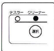
2 選択スイッチを押してクリーナーランプをON(点灯)します。
