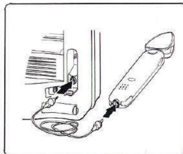
1 CHプレート専用コードを、本体のCHプレート専用ジャックへ差し込み、左図のようにCHプレートと本体をつないでください。
