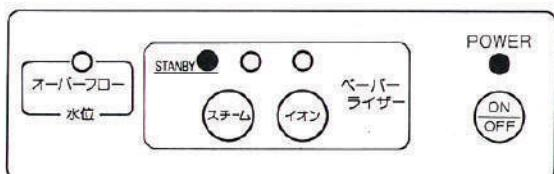
1 パワースイッチを押し、スタンバイランプが点灯し、オーバーフローランプが消灯しているのを確認してください。オーバーフローランプが点灯した場合は排水ボタンを押し、消灯するまで排水してください。
