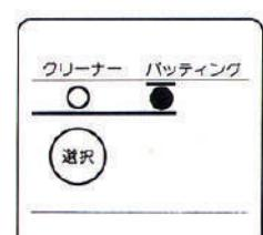
3 選択スイッチを押してバッティングランプをON(点灯)してください。
