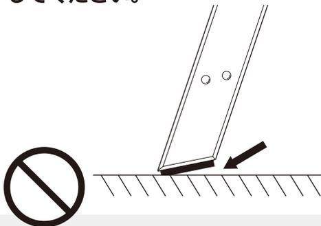
フロアマットやカーペット上に設置したり、両脚の底に何かを貼ると、使用者がバランスを崩して転落したり、はしごが脱落・破損する恐れがあります。
