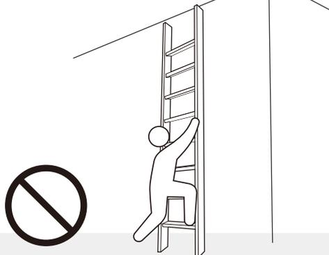
両脚が床面に接地していない状態では荷重に耐えられず、はしごが脱落・破損する恐れがあります。
