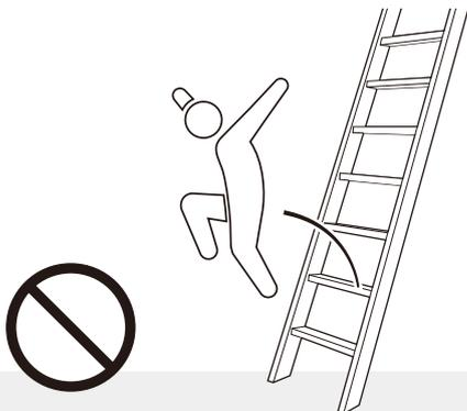
瞬間的に踏板へ大きな荷重がかかり、破損により落下しケガをする危険があります。
