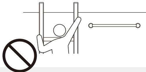
想定外の荷重がかかり、破損や足を滑らせて転落やケガをする危険があります。必ず適切な設置角度で使用してください。
